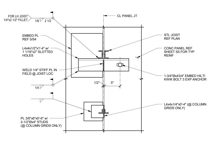
7 JOIST BEARING @ PANEL JOINT DETAIL
