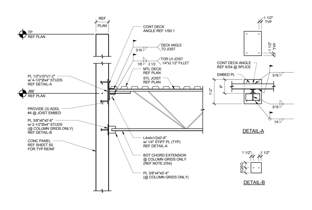
JOIST / JOIST GIRDER CONN SECTION
